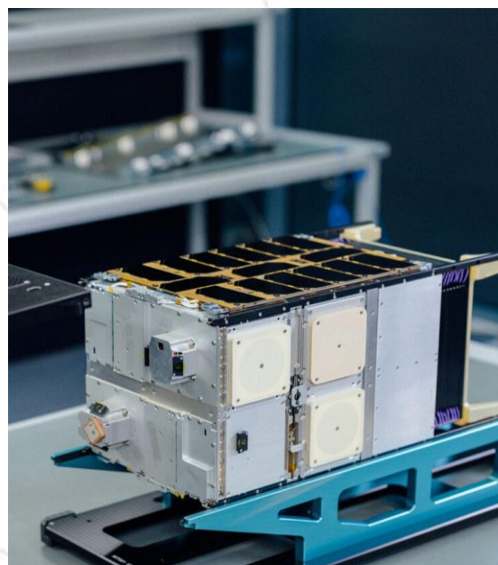
Danske satellitproducenter har succes med nano- og mikrosatellitter helt ned til skotøjsæske-størrelse og en kredsløbshøjde fra 250 km til 1.000 km. Her er det modellen IOD-1 fra GOMspace. Foto: GOMspace
