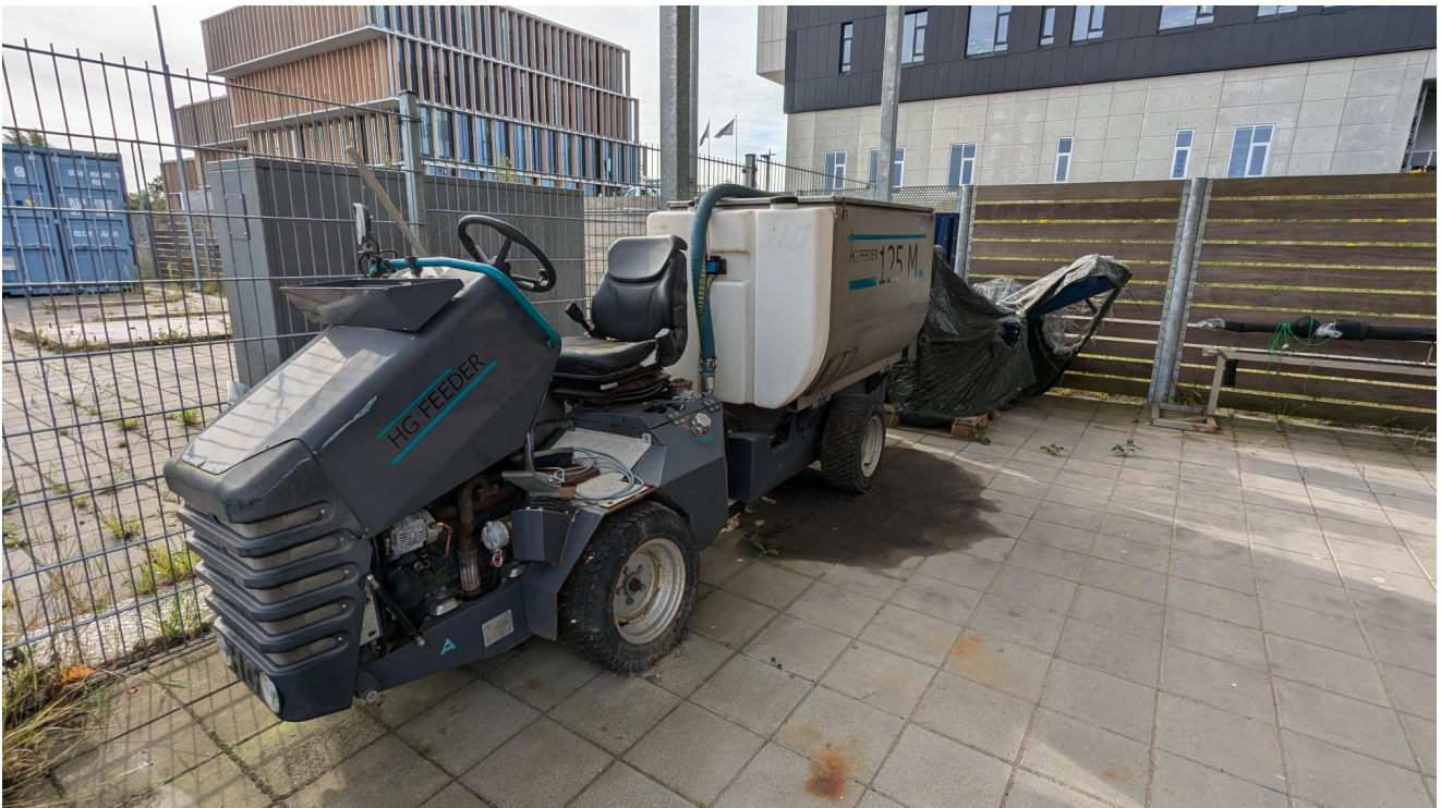
Andet udstyr: Ombygget fodervogn med rustfri tank og pumpe til håndtering af biomasse, eksempelvis spildevandsslam, biopulp og lign.
